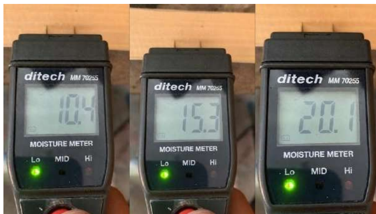
Gambar 4.2 Pengukuran kadar air pada kayu Sumber: Data diolah oleh peneliti
