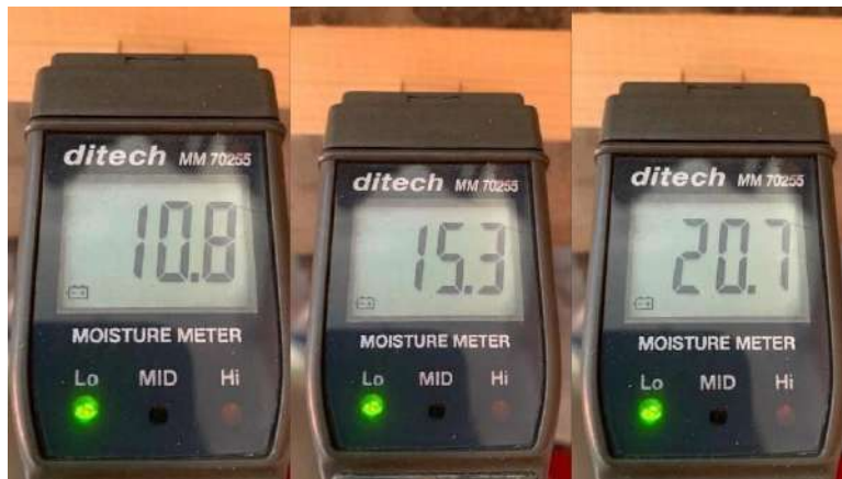
Gambar 4.3 Pengukuran kadar air pada kayu Sumber: Data diolah oleh peneliti
