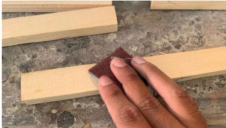
Gambar 4.1 Proses pengamplasan permukaan kayu Sumber: Data diolah oleh peneliti
