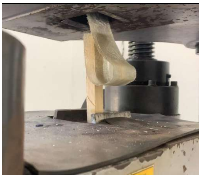
Gambar 4.9 Proses Peel Test Variasi Laminasi Langsung Sumber: Data diolah oleh peneliti
