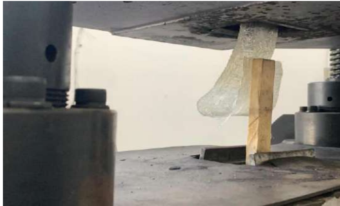
Gambar 4.10 Proses Peel Test Variasi Laminasi Resin Polyester Sumber: Data diolah Oleh Peneliti
