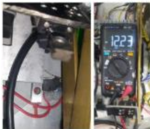
Gambar 4. 4 Gambar Pengujian Sensor Limit Switch (Documentasi Penulis, 2026)
