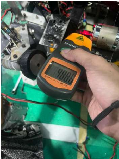
Gambar 4. 13 Pengujian motor PG-45 Penggerak ( Penulis, 2026 )
