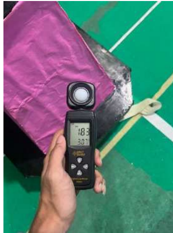
Gambar 4. 28 Pengujian Deteksi Robot berdasarkan Lux ( Penulis, 2026 )
