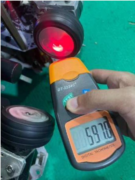
Gambar 4. 14 Pengujian Motor PG 36 Penggiring ( Penulis, 2026 )
