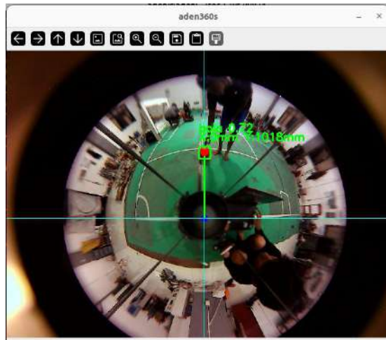
Gambar 4. 31 Deteksi Bola menggunakan YOLOv5s ( Penulis, 2026 )
