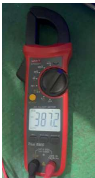
Gambar 4. 10 Pembacaan Tegangan Output pada VDC ( Penulis, 2026 )
