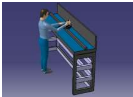
gambar 4. 55 Postur Kerja Pekerjaan Pemotongan Besi Hollow Setelah dilakukan Perbaikan
