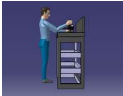
gambar 4. 54 Postur Kerja Pekerjaan Pemotongan Besi Hollow Setelah dilakukan Perbaikan
