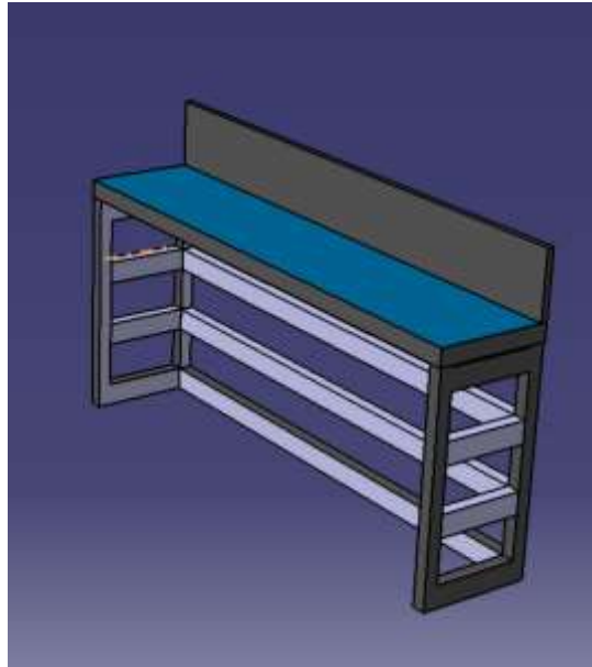
gambar 4. 52 Hasil Perancangan Meja Kerja Pemotongan Besi Hollow (Gambar 3D)
