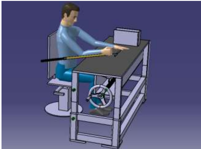
gambar 4. 46 Postur Kerja Setelah Dilakukan Perbaikan Pada Pekerjaan Pengelasan Besi Rebar
