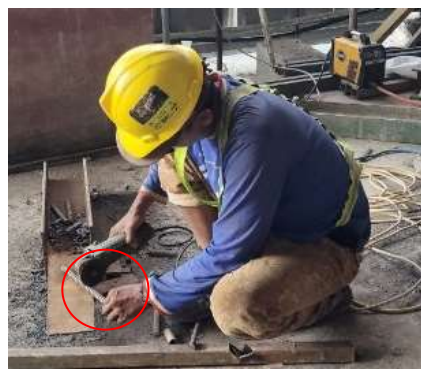
gambar 4. 17 Power grip pada mesin gerinda
