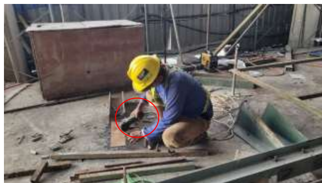
gambar 4. 16 Getaran lokal pada mesin gerinda
