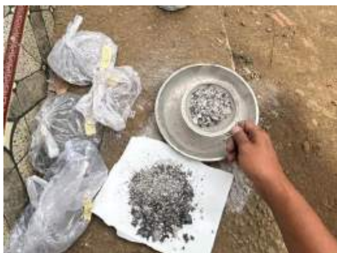
Gambar 4. 37 Proses Pengayakan Arang Dan Abu
