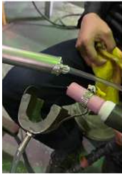
Gambar 3.5 Sistem Perlindungan Gas
