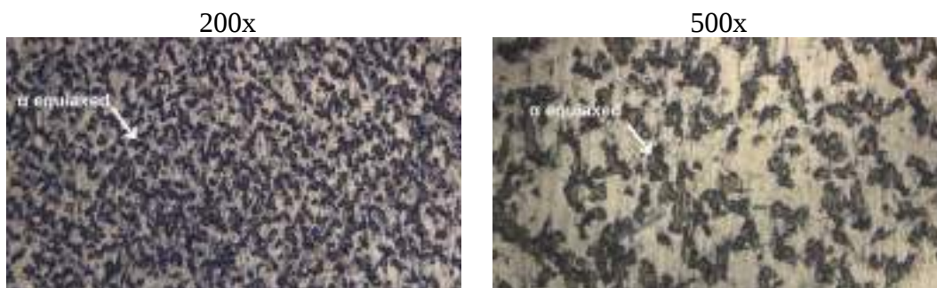
Gambar 4. 6 Struktur Mikro Daerah Base Metal
