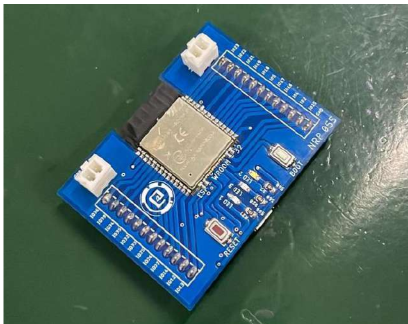
Gambar 4.2 Board ESP32 (Sumber: Dokumentasi Pribadi Penulis, 2026)
