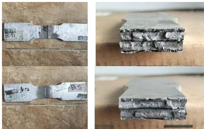
Gambar 4. 25 Hasil Patahan Uji Tarik Filler 4043 Suhu Ruang (B1)
