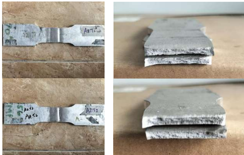
Gambar 4. 26 Hasil Patahan Uji Tarik Filler 5356 70° (A2)
