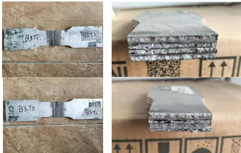
Gambar 4. 29 Hasil Patahan Uji Tarik Filler 5356 110° (B3)
