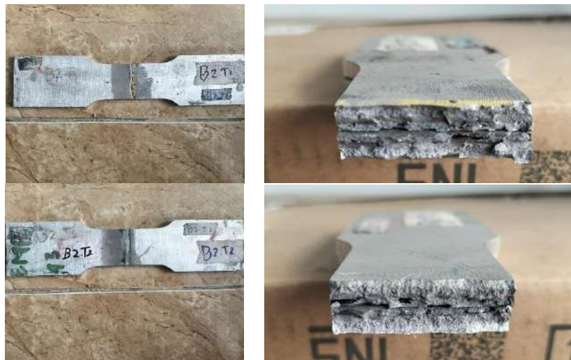
Gambar 4. 27 Hasil Patahan Uji Tarik Filler 4043 70° (B2)
