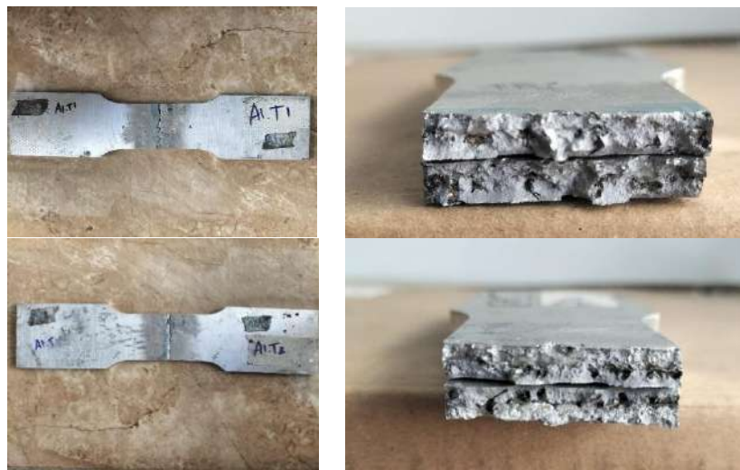
Gambar 4. 24 Hasil Patahan Uji Tarik Filler 5356 Suhu Ruang (A1)
