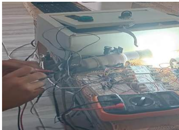
Gambar 4.9. Pengukuran Tegangan dari Relay 5v untuk lampu Sumber: Pribadi
