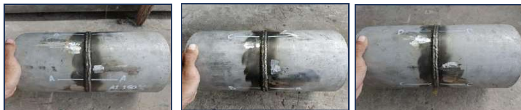
a). Interpass Temperature 150 °C
