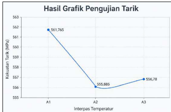
Gambar 4. 3 Grafik hasil rata-rata pengujian kekuatan uji tarik maksimum pada proses pengelasan GTAW-SMAW dengan variasi interpass temperature , A1. interpass temperature 150 °C, A2. interpass temperature 250 °C dan A3. tanpa interpass temperature (Dokumen Pribadi)
