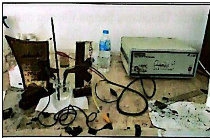
Gambar 3. 20 Pengujian Korosi Sel Tiga Elektroda (Fariz, 2024)
