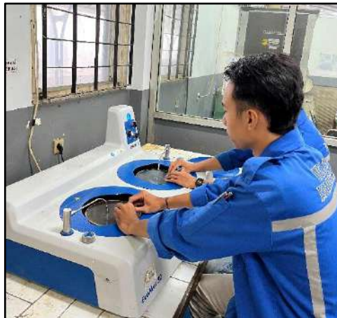
Gambar 3. 12 Proses Pemolesan Spesimen Uji (Sumber : Dokumen Pribadi)
