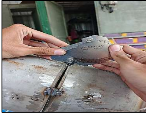
Gambar 3. 6 Join Desain Grove dan Root
