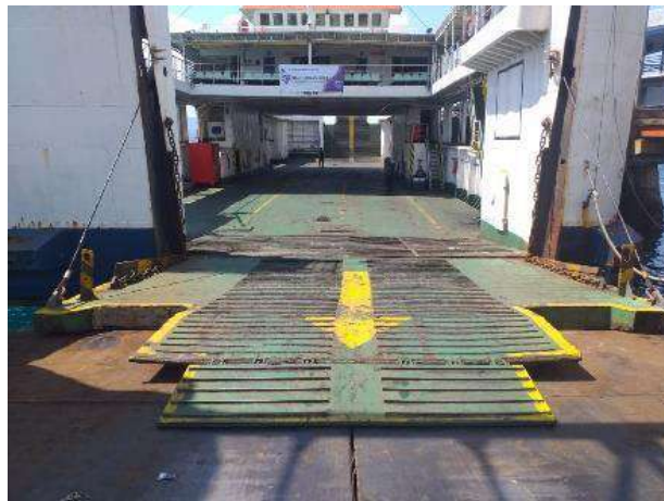
Gambar 2. 1 Ramp Door Kapal KMP. Marina Permata ( Dokumentasi Pribadi, 2025)
