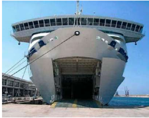
Gambar 2. 5 Slewing Ramp Door (www.macgregor.com)
