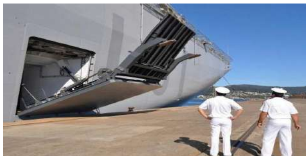
Gambar 2. 3 Side Ramp Door (www.macgregor.com)
