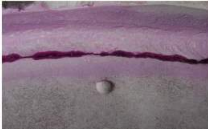
Gambar 2. 22 Indikasi pada Penetrant Test (SLV, 2015).
