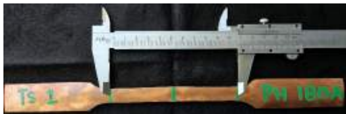
Gambar 3. 13 Spesimen Uji Tarik Pipa (ISO 4136, 2012)
