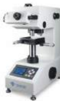
Gambar 2. 27 Mesin Uji Vickers (Munir dkk., 2019)
