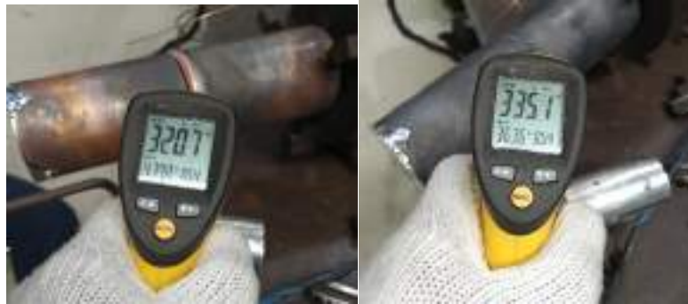
Lampiran B5 Lanjutan Pengukuran Temperature Preheat & Interpass untuk Variabel Non-preheat
