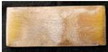
Gambar 3. 14 Spesimen Uji Laju Korosi Immersion
