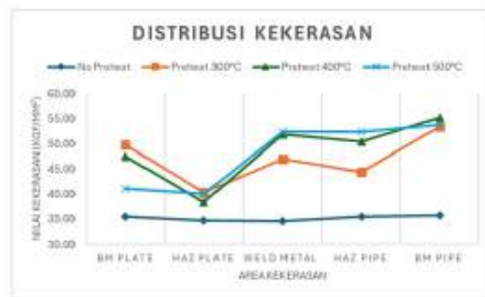
Gambar 2. 20 Distribusi Hardness pada Variasi No Preheat , Preheat 300°C, 400°C dan 500°C (Nurfian, 2025)
