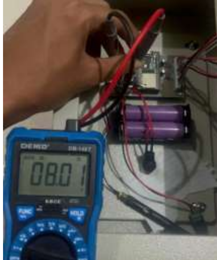
Gambar 4.3 Pengujian Parsial Input PCB
