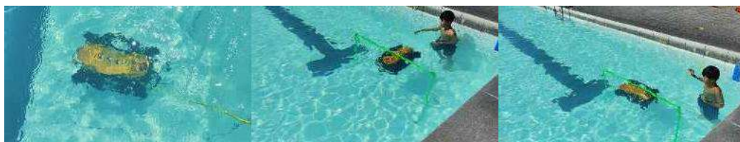
Gambar 4. 13 Proses Pengujian Gerak Dasar AUV pada Kolam Renang
