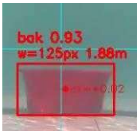
Gambar 3. 7 Proses Kalibrasi Koreksi Jarak Bawah Air Menggunakan Objek Referensi (bak) dengan Pembacaan Jarak Melalui Deteksi YOLO
