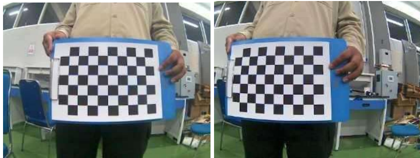
Gambar 3. 6 Proses Kalibrasi Stereo Menggunakan Papan Catur Tampak Kiri dan Kanan (Checkerboard)
