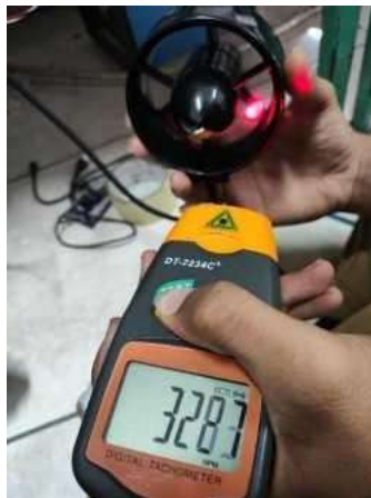
Gambar 4. 11 Pengujian Motor Thruster Menggunakan Kontroler ESP32
