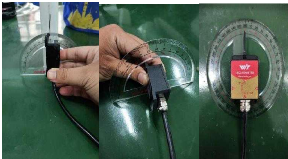
Gambar 4. 5 Pengujian Nilai Sensor HWT905 dengan Busur
