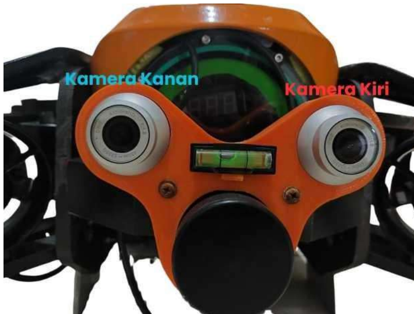
Gambar 3. 4 Pemasangan Dua Kamera DWE exploreHD sebagai Stereo Pair pada AUV
