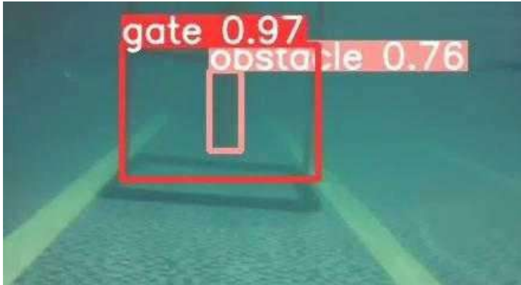
Gambar 2. 3 Contoh visualisasi hasil persepsi lingkungan AUV terhadap rintangan dan target
