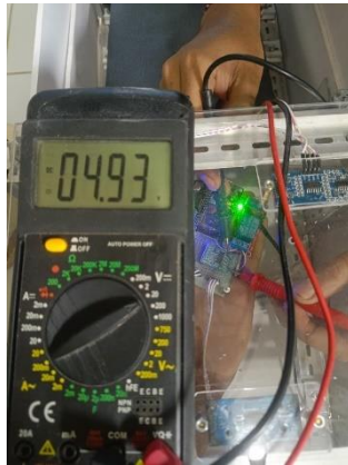
Gambar 4. 12 Pengujian Tegangan Load cell Sumber : Dokumentasi penelitian
