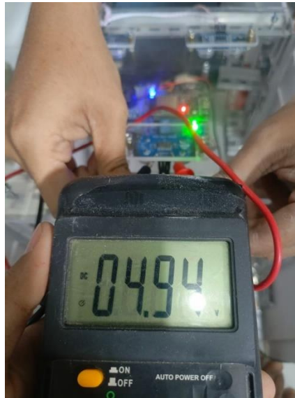
Gambar 4. 9 Pengujian Tegangan Sensor Ultrasonik
