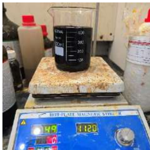
Penambahan larutan amonium hingga pH 10 dan terjadi presipitasi
