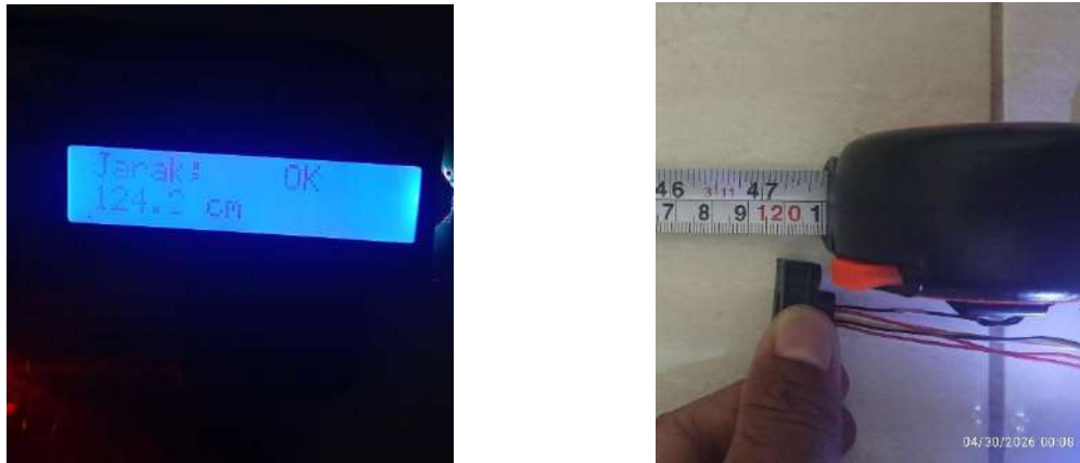
Gambar 4. 9 Pengujian Sensor LIDAR TF-LC02
