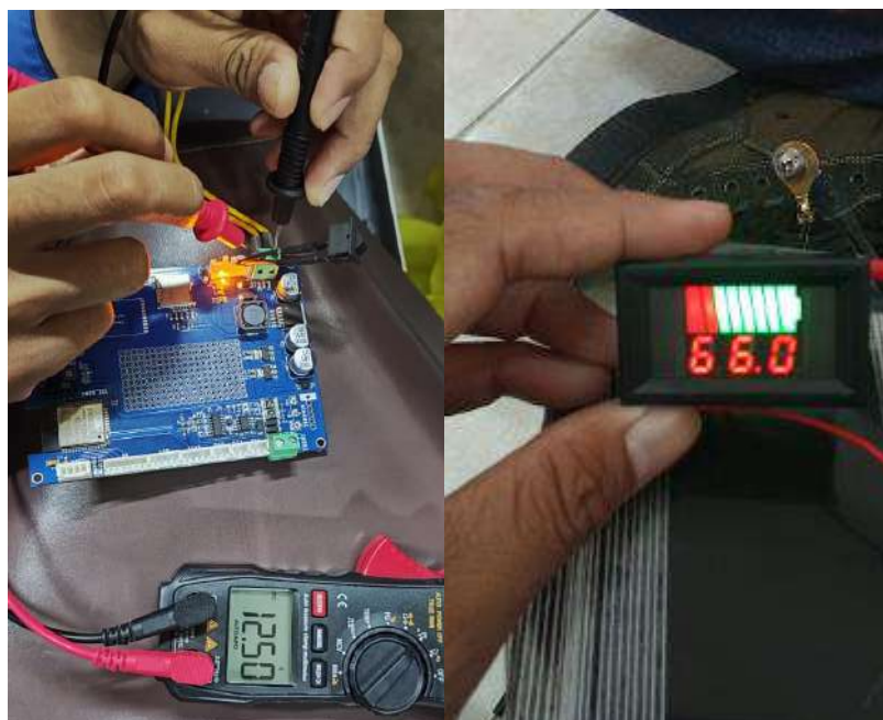
Gambar 4. 19 Pengujian Converter 60V ke 12V
