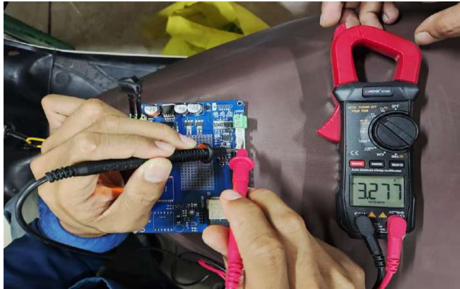
Gambar 4. 4 Pengujian Tegangan Catu Daya 3.3V
