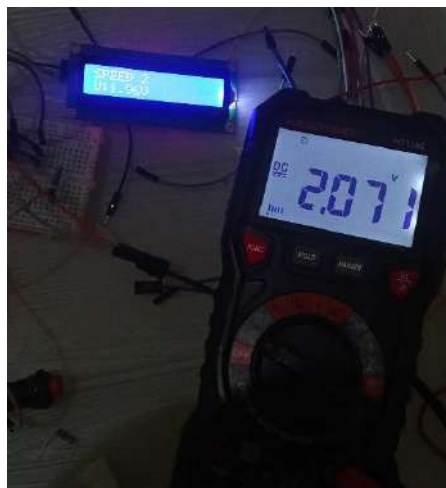
Gambar 3. 28 Pengujian Signal DAC MCP4725 sebagai pengganti Throttle
