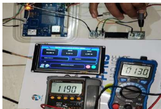
Gambar 4. 16 Pengujian Tegangan dan Arus Sensor PZEM
