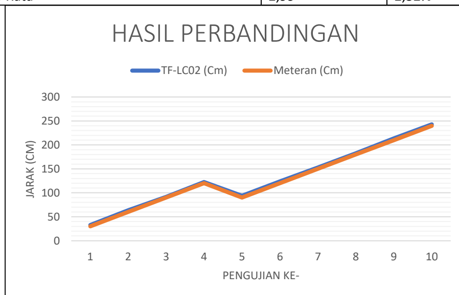
Gambar 4. 10 Grafik Perbandingan antara TF-LC02 dan Meteran
