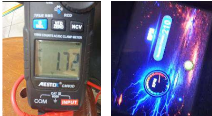
Gambar 4. 15 Pengukuran Tegangan Sinyal Throttle dan RPM
