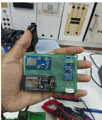
Gambar 3. 31 Pengujian SD-card sebagai Data Logger
