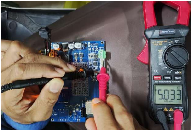
Gambar 4. 3 Pengujian Tegangan Catu Daya 5V
