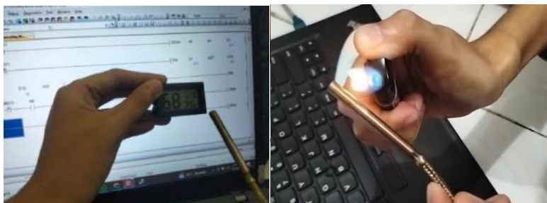
Gambar 4. 19 Pengujian Sensor Thermocouple RTD PT100 (Sumber: Dokumentasi Pribadi)
