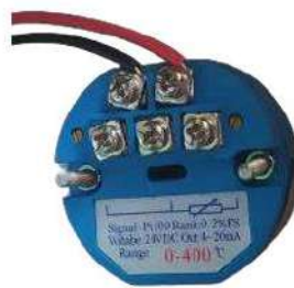
Gambar 2. 14 Transmitter PT100 (Sumber: Dokumentasi Pribadi)
