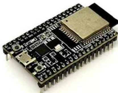
Gambar 2. 2 Modul ESP32 (Sumber: Amazon.com)
