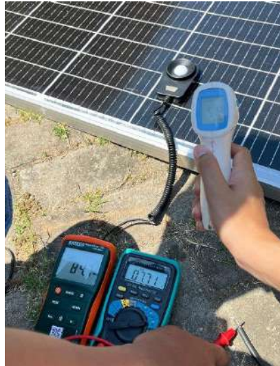
Gambar 4. 5 Pengujian Panel Surya
