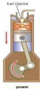
Gambar 2. 5 Langkah Usaha Mesin Diesel 4 Tak (Anwar M, 2020)
