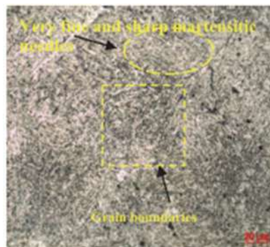
Gambar 2. 10 Struktur Mikro Material H13 Ditempering Satu Kali (Shelar & Ronge, 2023)
