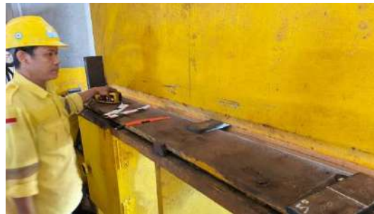
Gambar 3. 4 Proses Hot Bending (A) Pemansan Material, (B) Proses Memasukan Material Pada Mesin Bending (C) Proses Bending (Dokumen Pribadi, 2026)
