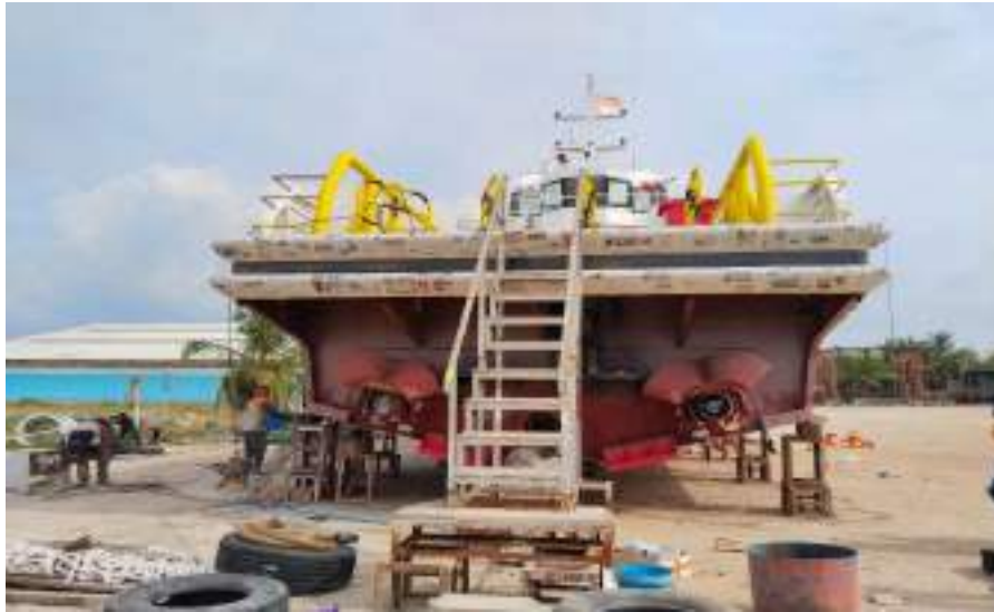
Gambar 2.2 Pekerjaan Docking Repair pada Crew Boat (Dokumentasi Penulis, 2025)
