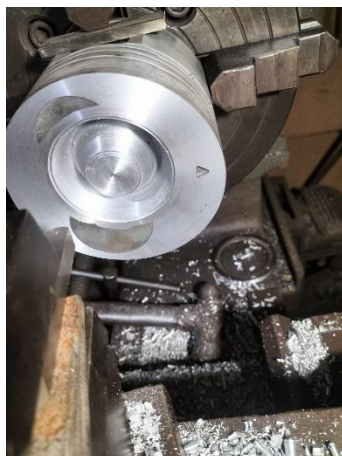
Gambar 4.5 Proses Pembentukan Toroidal Piston Bowl Geometry (TPBG) Sumber : (Dokumentasi Pribadi)
