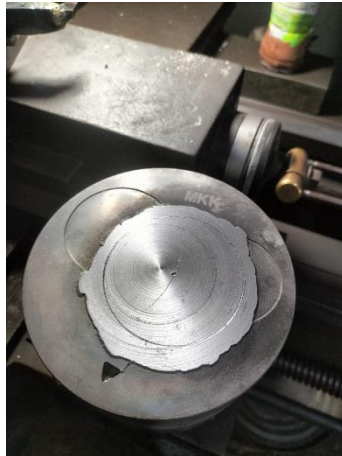
Gambar 4.4 Hasil Perataan Permukaan Piston Dengan Menggunakan Mesin Bubut Sumber : (Dokumentasi Pribadi)
