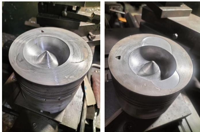
Gambar 4.6 Finish Pembentukan Toroidal Piston Bowl Geometry (TPBG) Sumber : (Dokumentasi Pribadi)
