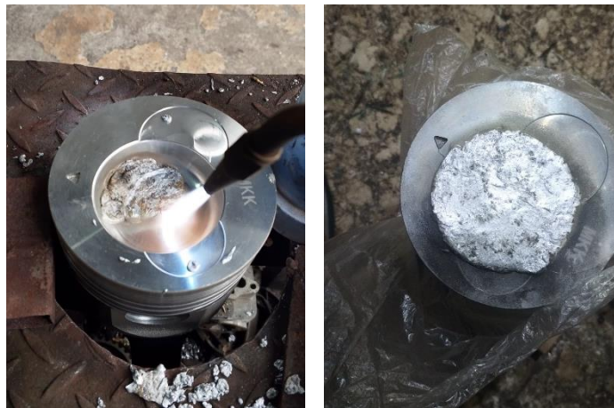
Gambar 4.3 Penambahan Material Aluminium Cor Pada Crown Piston Dengan Proses Pengelasan
