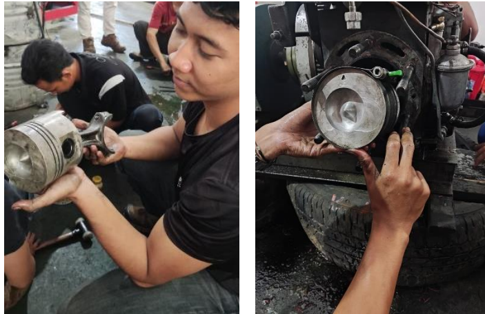
Gambar 4.7 Proses Instalasi Toroidal Piston Bowl Geometry (TPBG) Pada Motor Diesel Sumber : (Dokumentasi Pribadi)
