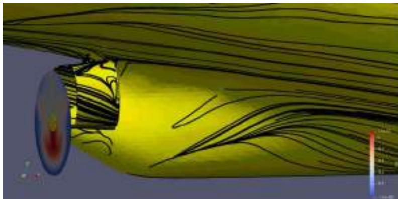
Gambar 1.1 Separasi yang masih terjadi meskipun WED dipasang
