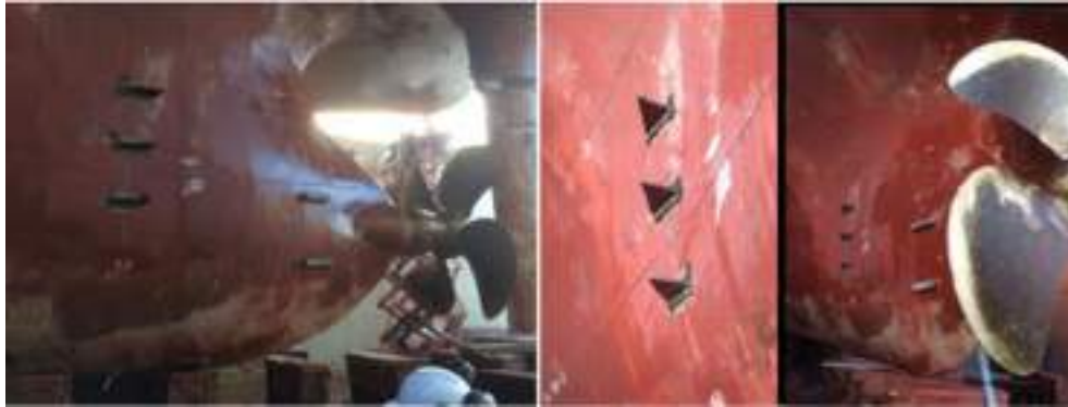
Gambar 2.3 Vortex Generator Fins (VGF) (Saydam et al. , 2018)
