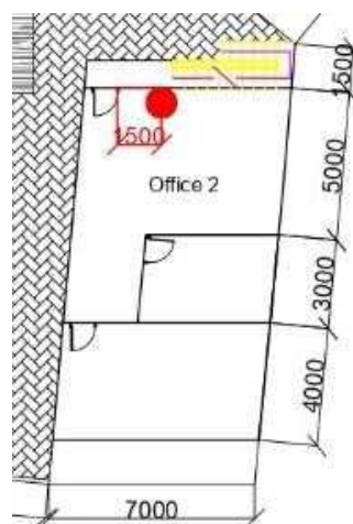
Gambar 4. 10 Layout Rekomendasi Penempatan Titik Panggil Manual pada Workshop Fabrikasi Lantai 2
