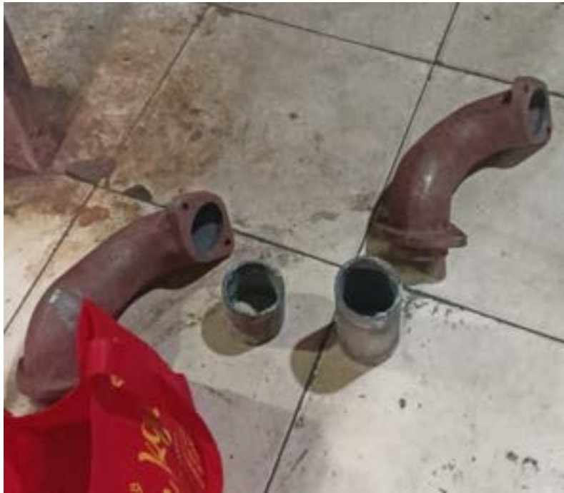
Gambar 4. 2 Proses modifikasi Intake manifold 42 cm & 52 cm
