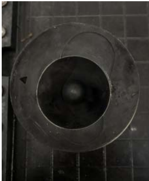
Piston TPBG Setelah Digunakan Untuk Pengujian.
