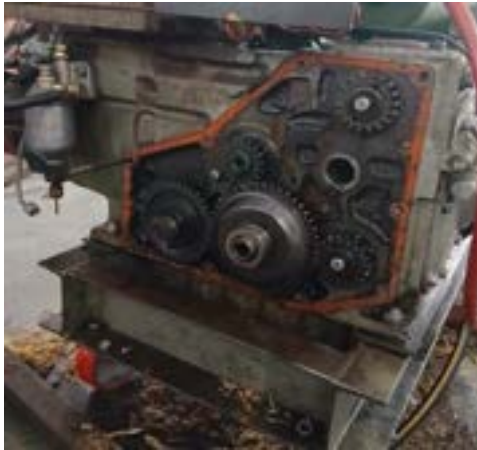
Proses Pembongkaran Boschpump Lama.
