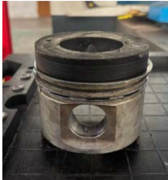
Piston TPBG Setelah Digunakan Untuk Pengujian.
