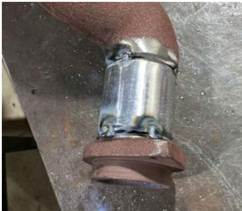
Gambar 4. 2 Proses modifikasi Intake manifold 42 cm & 52 cm
