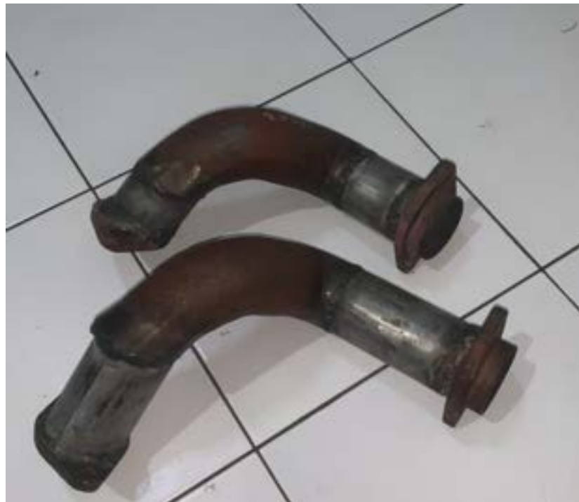
Gambar 4. 5 Hasil modifikasi Intake manifold 42 cm & 52 cm
