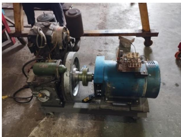
Gambar 3. 2 Jiangdong Diesel Engine Dikopel dengan Generator (sumber: Dokumentasi Pribadi)
