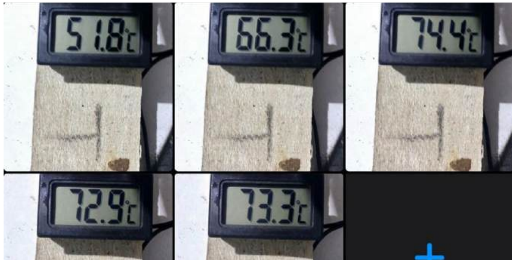
Lampiran 5 Suhu T2 pada posisi keluar kompresor
