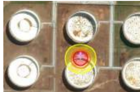
Gambar 4. 23 Thermal Radiation Area Arah Mata Angin dari Utara Ukuran Lubang Kebocoran Medium
