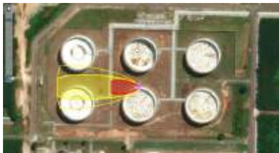
Gambar 4. 14 Flammable Area of Vapor Arah Mata Angin dari Timur
