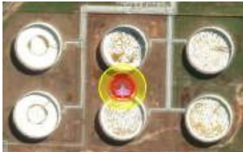
Gambar 4. 22 Thermal Radiation Area Arah Mata Angin dari Selatan Ukuran Lubang Kebocoran Medium
