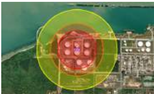
Gambar 4. 34 Thermal Radiation Area Arah Mata Angin dari Timur Ukuran Lubang Kebocoran Rupture
