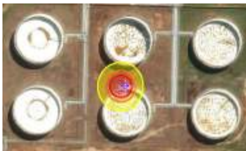
Gambar 4. 24 Thermal Radiation Area Arah Mata Angin dari Timur Ukuran Lubang Kebocoran Medium
