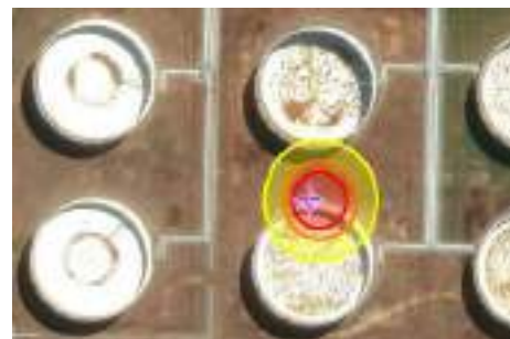
Gambar 4. 25 Thermal Radiation Area Arah Mata Angin dari Barat Ukuran Lubang Kebocoran Medium
