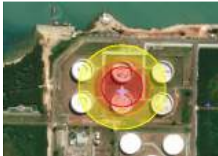
Gambar 4. 27 Thermal Radiation Area Arah Mata Angin dari Selatan Ukuran Lubang Kebocoran Large
