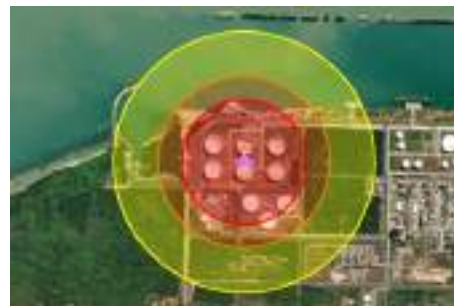
Gambar 4. 35 Thermal Radiation Area Arah Mata Angin dari Barat Ukuran Lubang Kebocoran Rupture
