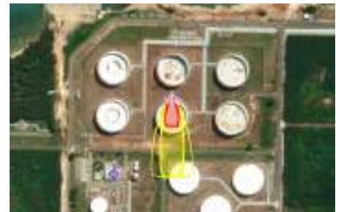
Gambar 4. 13 Flammable Area of Vapor Arah Mata Angin dari Utara
