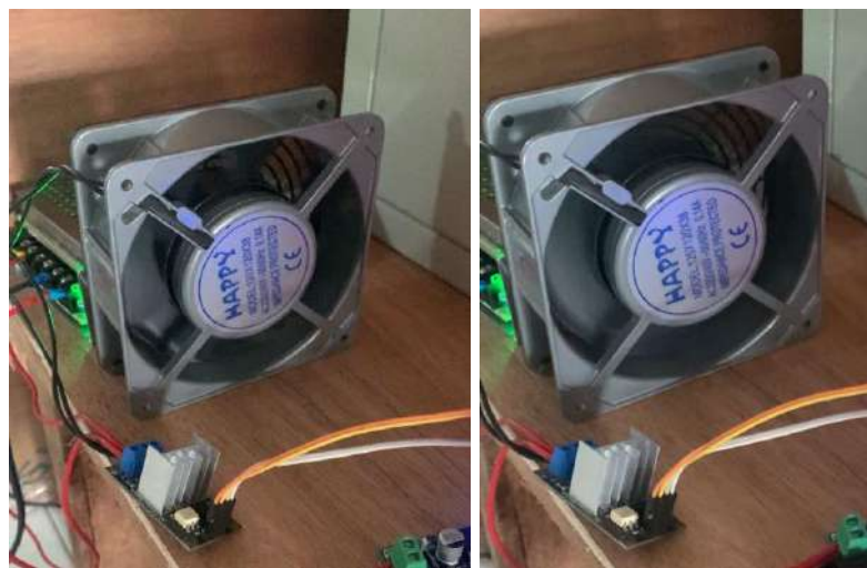
Gambar 4. 14 Pengujian Fan AC 220V saat on dan off.
