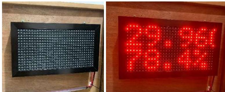
Gambar 4. 20 Kondisi Module P10 mati dan kondisi Module P10 menyala.
