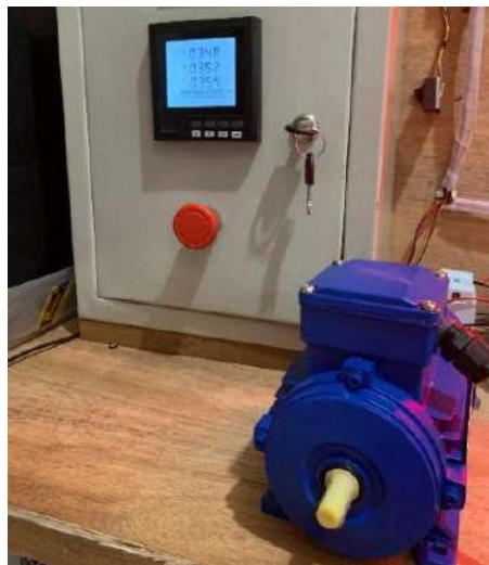
Gambar 4. 12 Pengujian Power meter dengan Motor 3 fasa.
