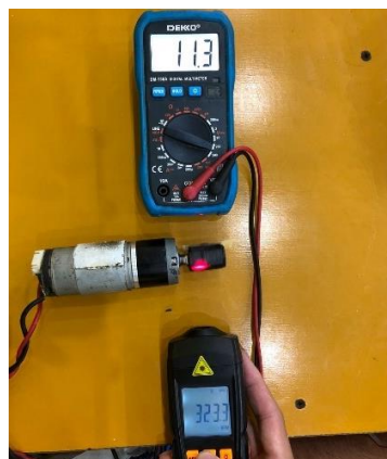
Gambar 4. 16 Pengujian Motor DC (Sumber: Dokumentasi Pribadi)
