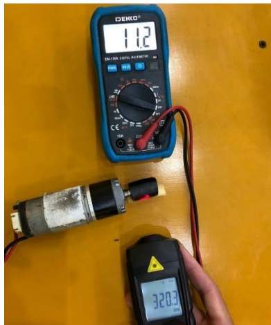
Gambar 4. 15 Gambar Pengujian Motor Berlawanan jarum jam (Sumber: Dokumentasi Pribadi)
