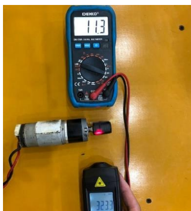
Gambar 4. 13 Gambar Pengujian Motor searah jarum jam
