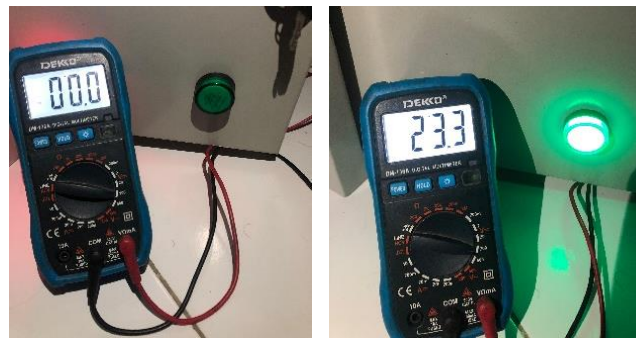
Gambar 4. 9 Pengujian Pilot Lamp Hijau (Sumber: Dokumentasi Pribadi)
