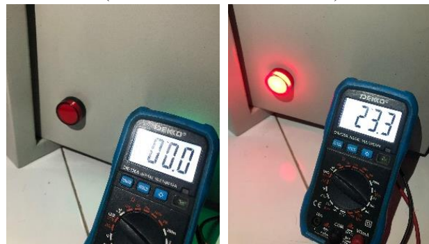
Gambar 4. 10 Pengujian Pilot Lamp Merah (Sumber: Dokumentasi Pribadi)
