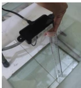
Gambar 4. 7 Pengujian Ultrasonik Water Level Sensor (Sumber: Dokumentasi Pribadi)
