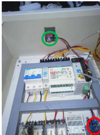
Gambar 4.30 Letak Sensor MQ-2 (Dokumentasi Pribadi)
