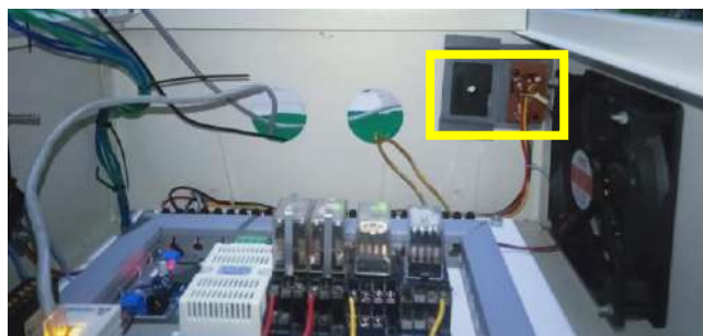
Gambar 4.39 Letak Sensor Debu (Dokumentasi Pribadi)
