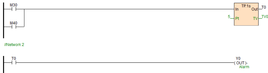
Gambar 4.52 Program PLC Alarm (Dokumentasi Pribadi)
