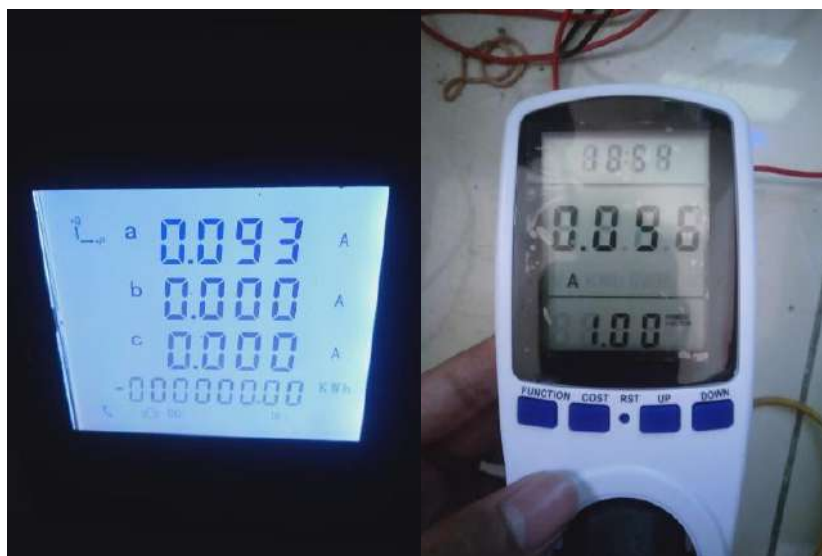
Gambar 4.13 Pengujian Arus (Dokumentasi Pribadi)
