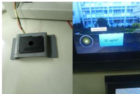
Gambar 4.41 Percobaan Sensor Debu di Luar Panel (Dokumentasi Pribadi)
