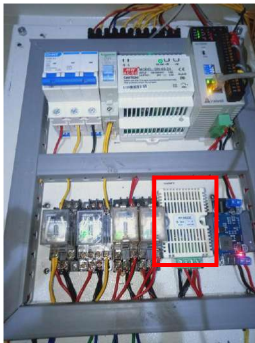
Gambar 4.23 Letak Sensor SHT20 (Dokumentasi Pribadi)
