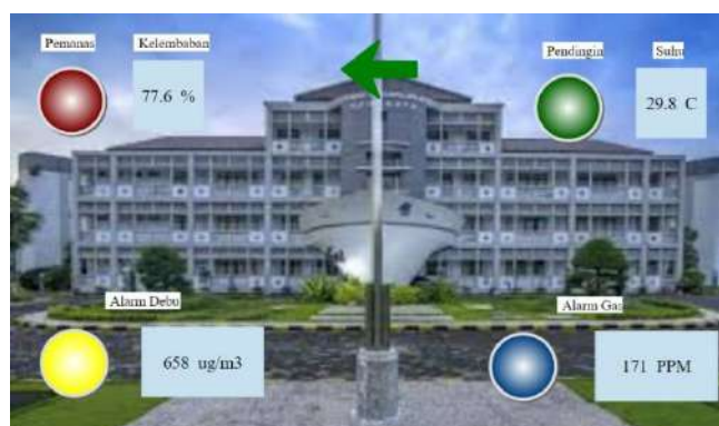
Gambar 4.53 Hasil Alarm Untuk Debu (Dokumentasi Pribadi)
