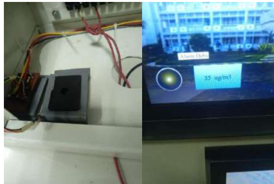
Gambar 4.40 Percobaan Sensor Debu di Dalam Panel (Dokumentasi Pribadi)
