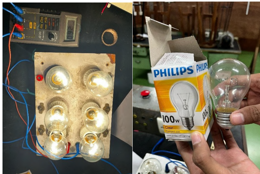
Gambar 4.1 Pengujian sensor PZEM-004t dengan wattmeter
