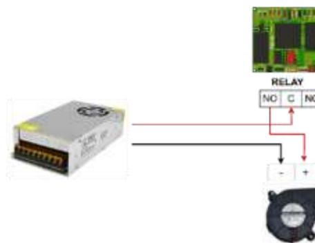
Gambar 4. 16 Wiring relay dan fan Sumber : Dokumen Pribadi Penulis
