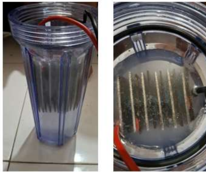
Gambar 4. 21 Percobaan Elektrolisis Sumber : Dokumen Pribadi Penulis
