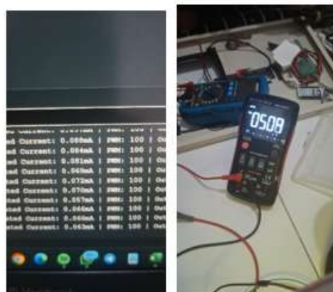
Gambar 4. 13 Pengujian Sensor Arus Sumber : Dokumen Pribadi Penulis
