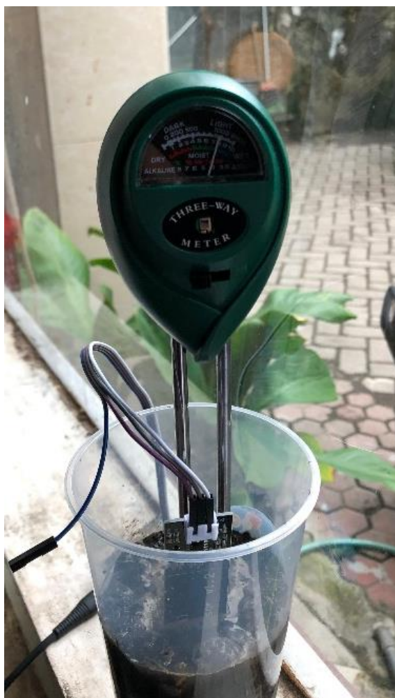
Gambar 4.9 Percobaan sensor Soil Moisture dengan soil meter
