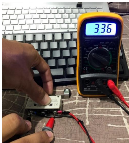
Gambar 4.7 Pengujian limit switch
