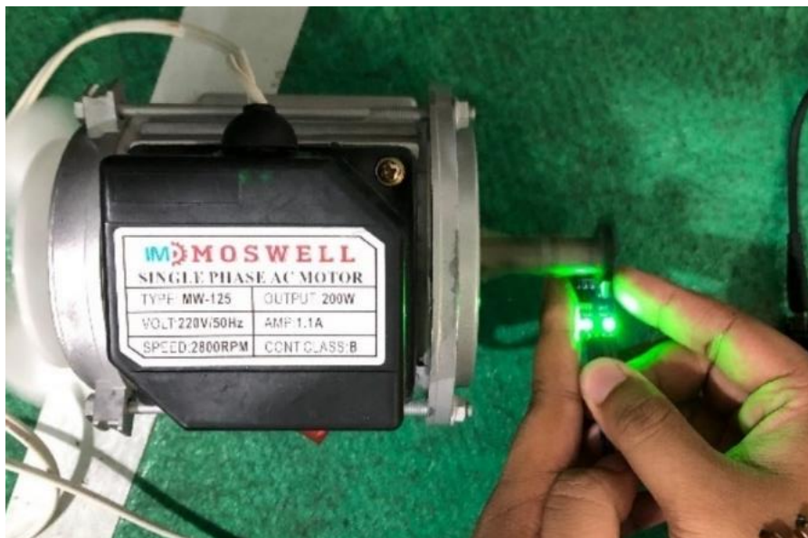
Gambar 4.5 Pengukuran sensor pada kecepatan putaran motor
