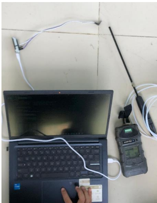
Gambar 4.8 Percobaan sensor MiCS 5524 dengan MSA Altair 5X Detect
