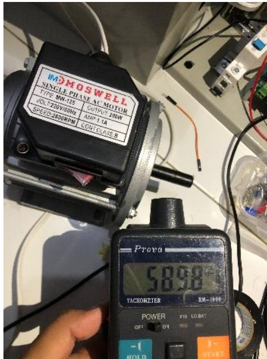
Gambar 4. 3 Uji aktuator Motor AC 1 Phase.
