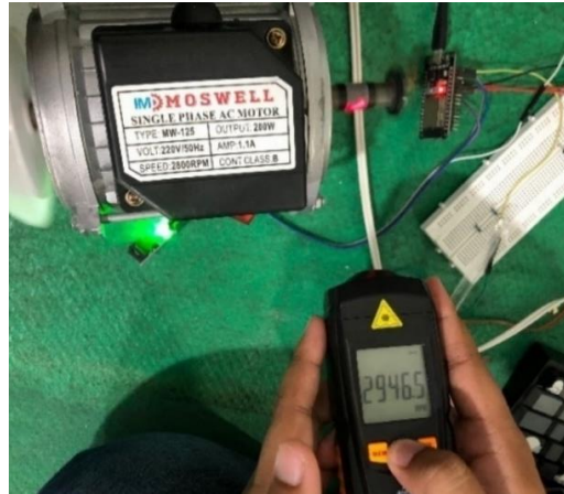
Gambar 4.6 Pengukuran rpm pada motor menggunakan tachometer
