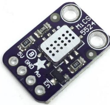
Gambar 2.6 Sensor MICS 5524 Gas CO (Sumber cytron.io.com)
