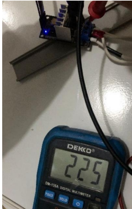
Gambar 4.4 Uji aktuator AC dimmer
