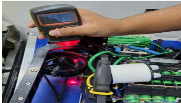
Gambar 4. 7 Pengujian Kecepatan Motor Thruster Menggunakan Tachometer
