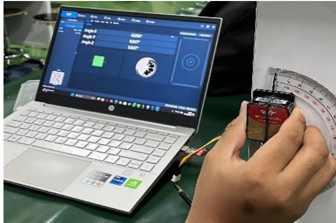
Gambar 4. 6 Perhitungan Sudut HWT905 Attitude Angle Sensor dengan Busur
