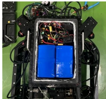
Gambar 4. 18 Wiring Electric pada Enclosure Bawah
