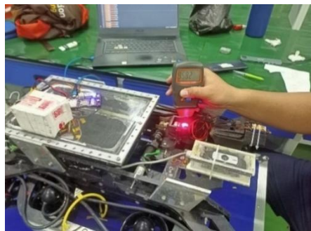
Gambar 4. 8 Proses Pengukuran Kecepatan BLDC Motor Menggunakan Tachometer
