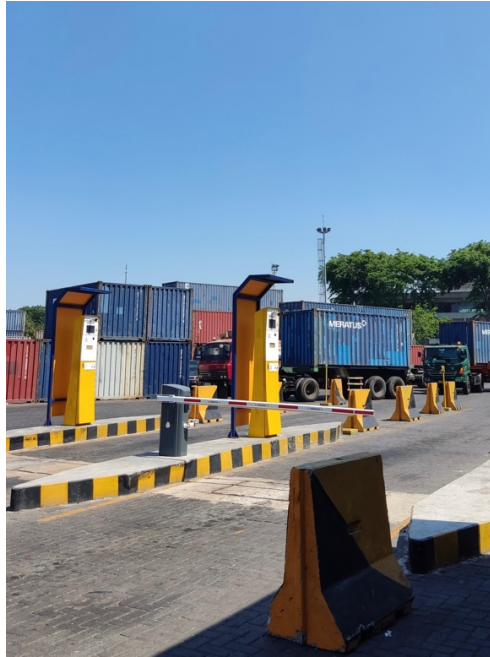
Gambar 2.4. Alat Auto Gate System (Depo Petikemas Surabaya, 2024)
