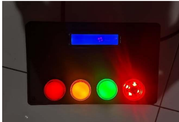
Gambar 4. 16 Kondisi aktual lampu saat relay ON
