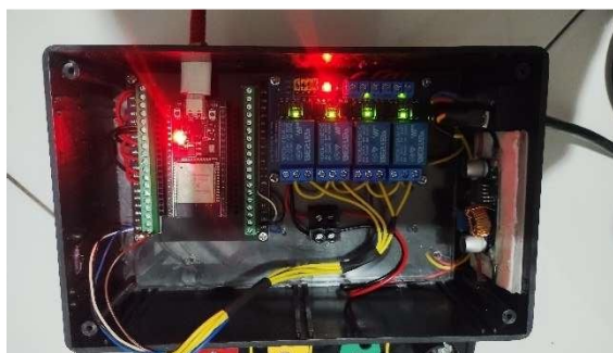
Gambar 4. 15 Hasil pengujian relay lampu kondisi ON
