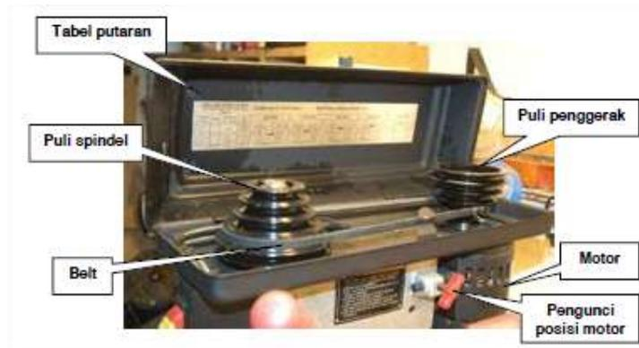
Gambar 113. Transmisi bor lima tingkat
