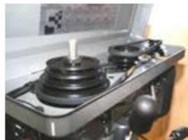
Gambar 114. Transmisi bor 12 tingkat kecepatan
