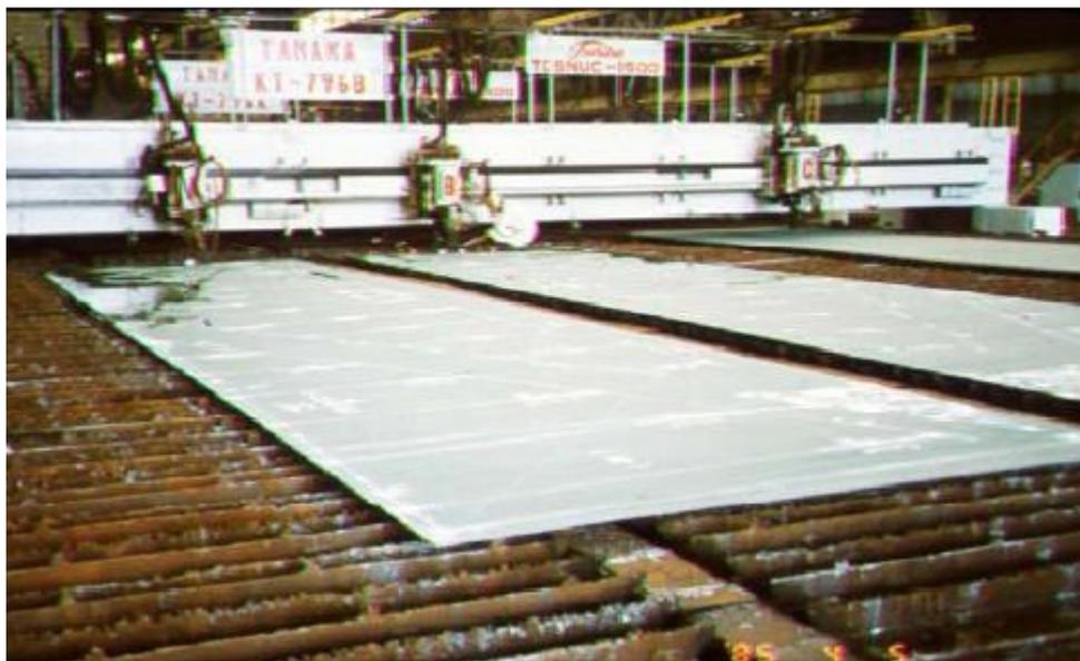
**Gambar 1.6** Marking pada plat
