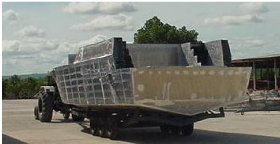
**Gambar 2.** Pemindahan blok menuju proses *errection*
