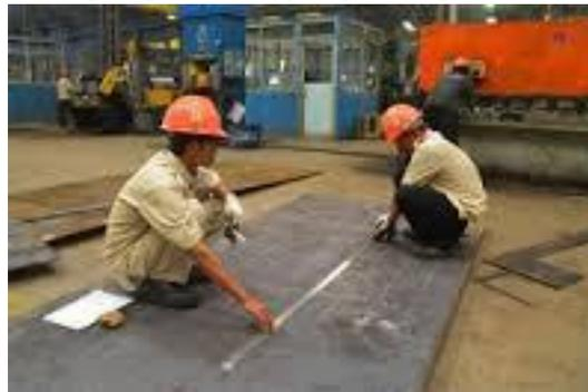
**Gambar 5.** Proses Marking pada plat
