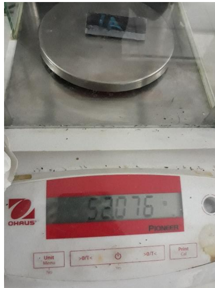
Gambar 4.15 Penimbangan Sebelum Immersion Test
