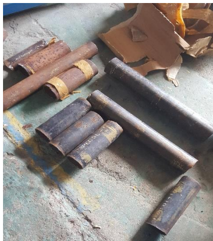
Gambar 4.1 Spesimen Pipa API 5L Gr B
