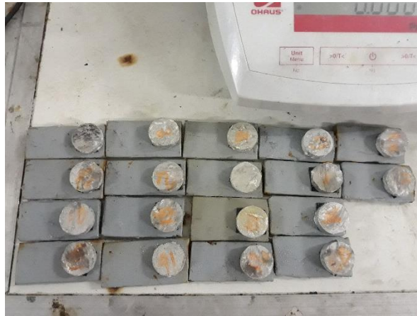
Gambar 4.14 Pemasangan Anoda Magnesium
