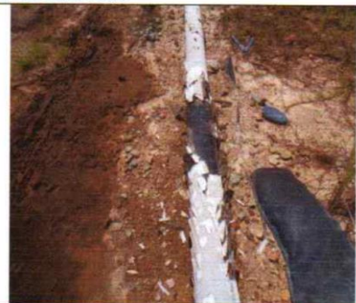
Wrapping terkelupas pada jarak 15 m
