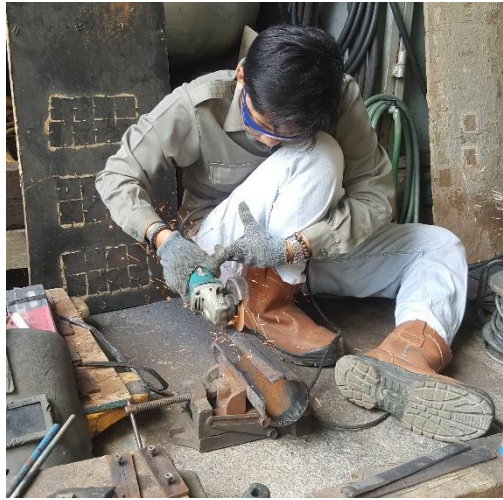
Gambar 4.2 Proses Pemotongan Spesimen
