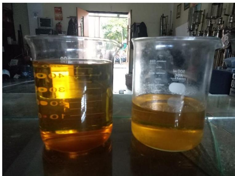
Kiri biodiesel yg sudah dicuci, kanan biodiesel yang belum dicuci
