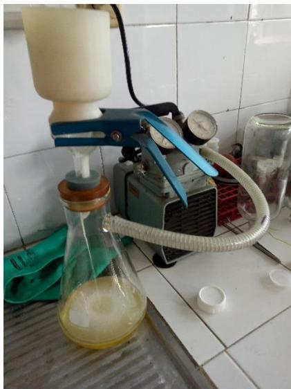
Proses Penyaringan Minyak Jelantah dengan *Vaccum Pump*
