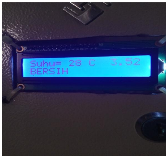
Gambar 4.3 Pengujian Tampilan LCD
